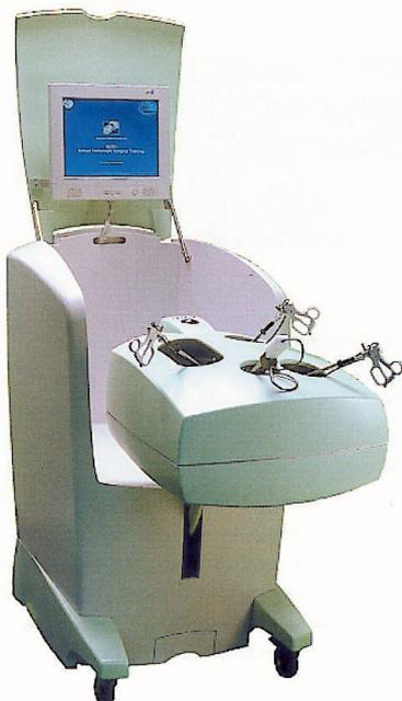
Das Erlernen mikroinvasiver Chirurgetechniken kann heute kostengünstig und hochflexibel mittels Virtual-Reality-Modellen realitätsgetreu erfolgen. Im Auftrag der Select-IT AG, Bremen, entwickelte das i/i/d mit dem MIC-Trainer ein innovatives, integriertes Gerätedesign, das international bereits auf große Resonanz stieß.
